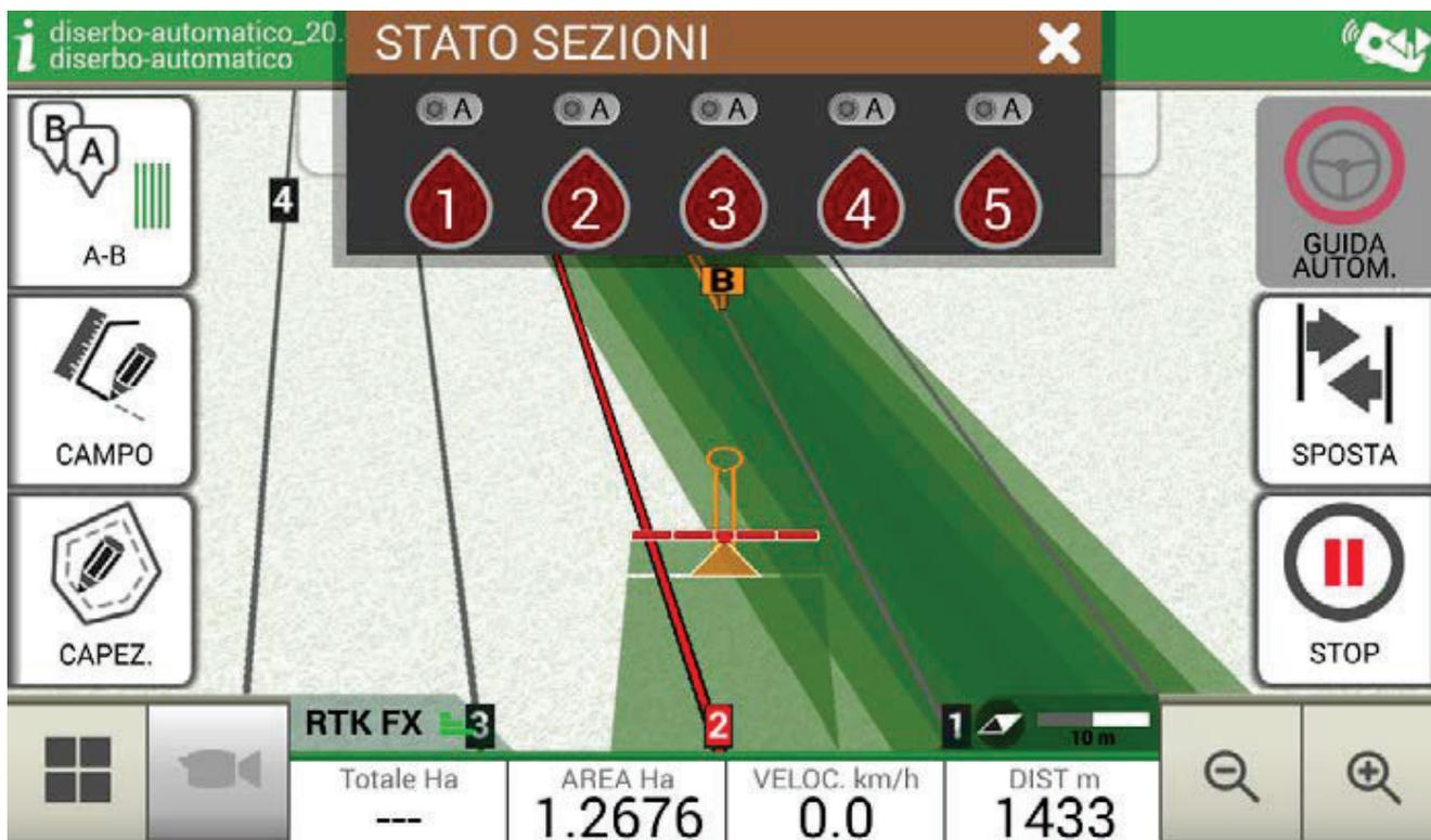
Figura 4.10.m - Barra de estado de la sección
