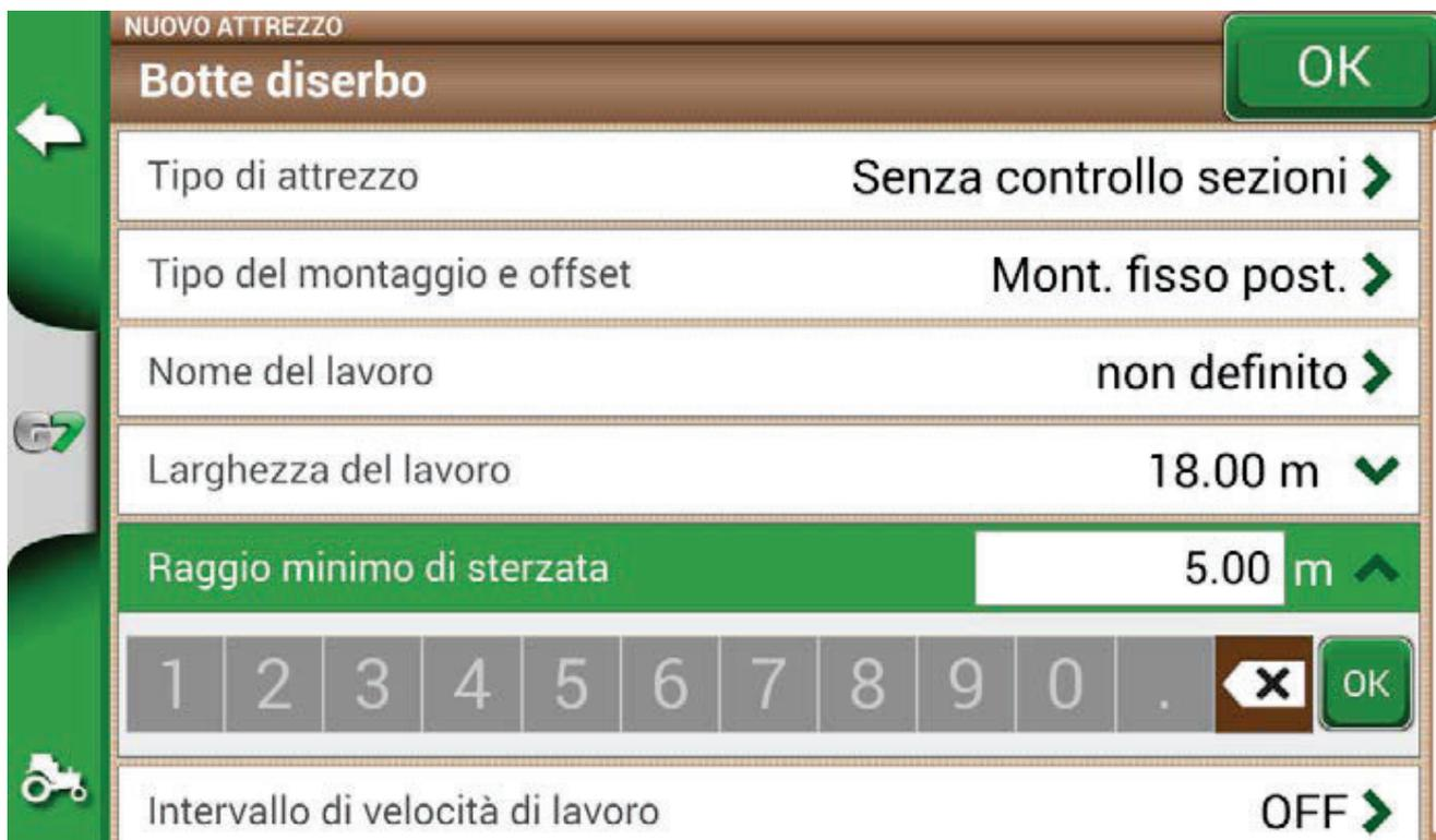
Figura 2.1.6.i - Introduzione del radio mínimo de giro del tractor
