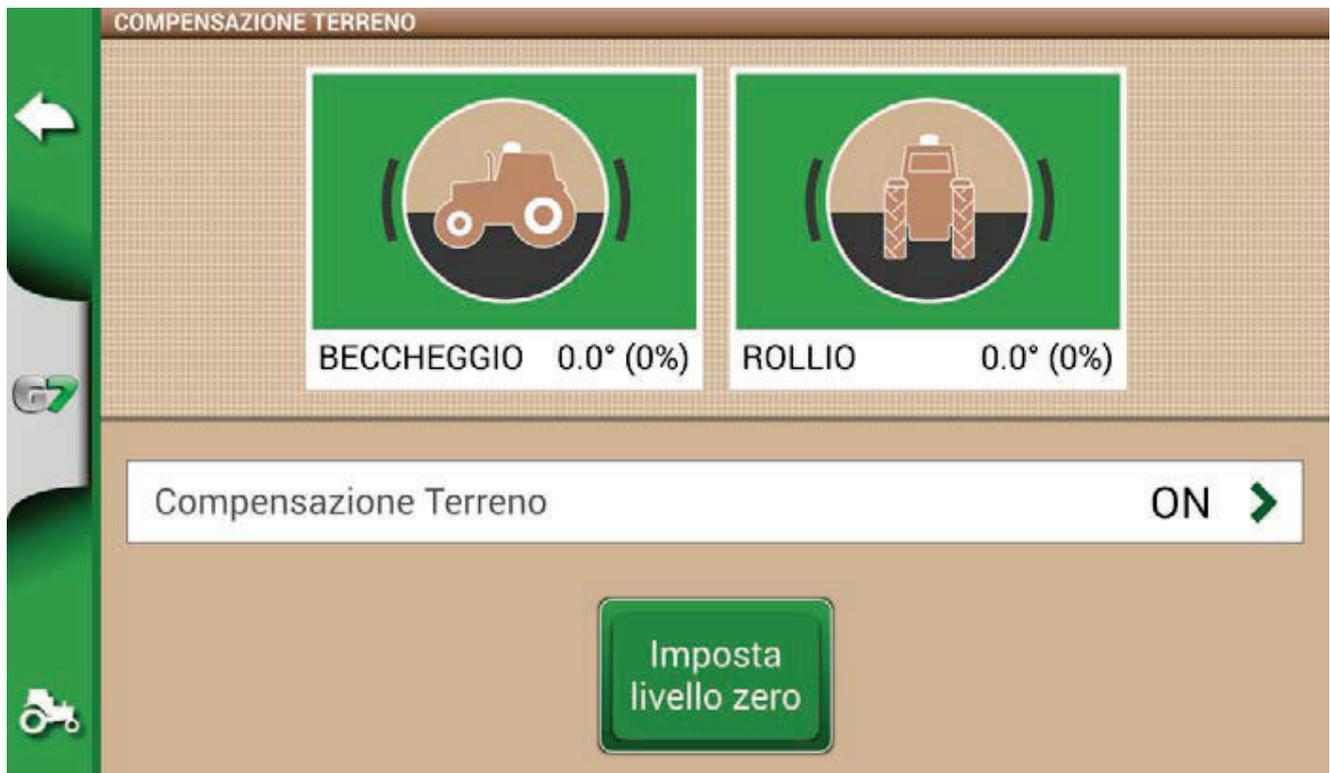
Figura 2.4.1.d – Calibración cero de compensación del terreno
