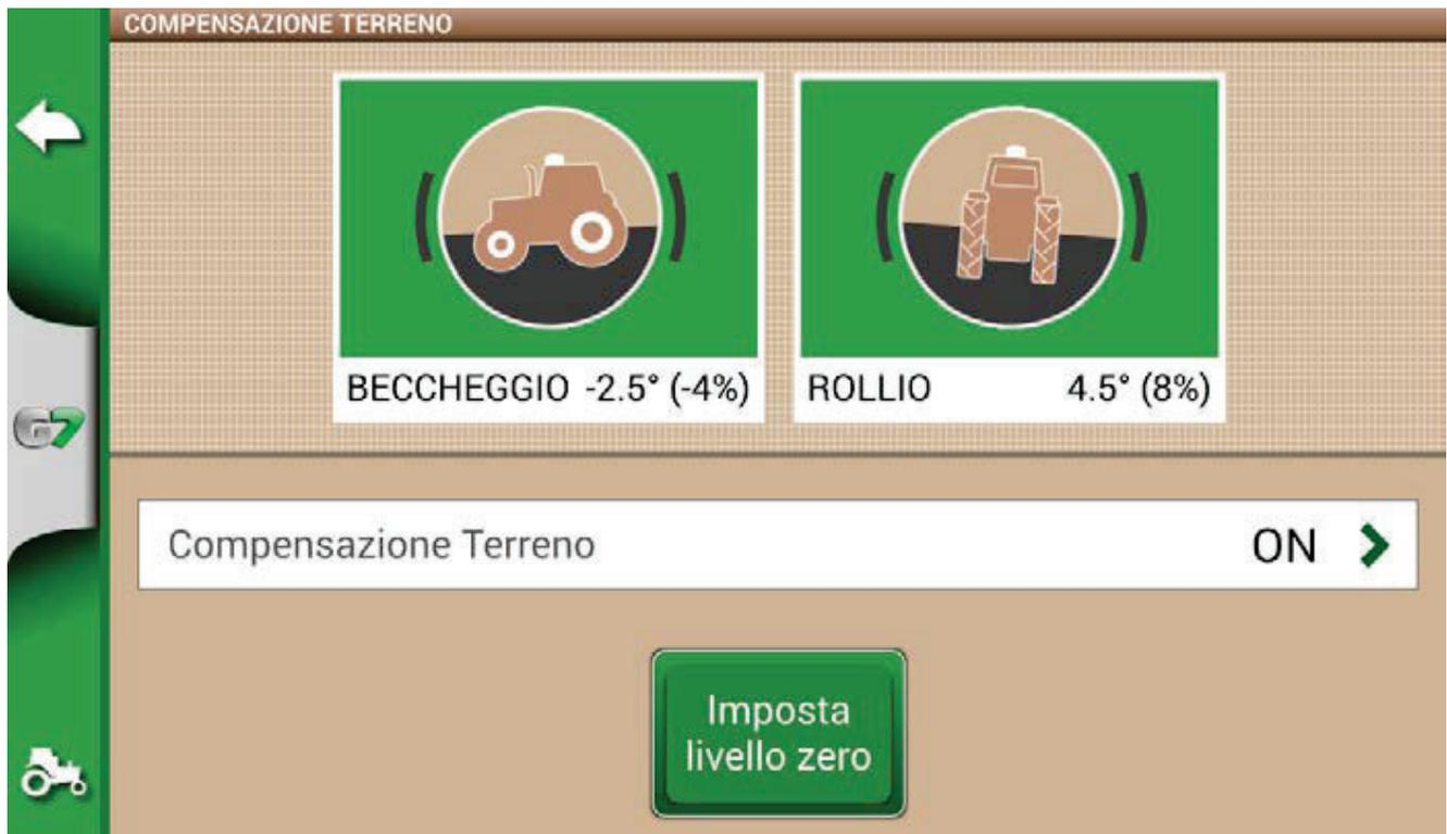
Figura 2.4.1.c – Activación de compensación del terreno, visualización de cabeceo/balaceo
