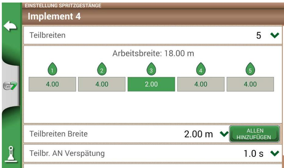
Abbildung 4.10.i – Beispiel eines 18 Meter langen Gestänges mit 5 Teilbreiten
