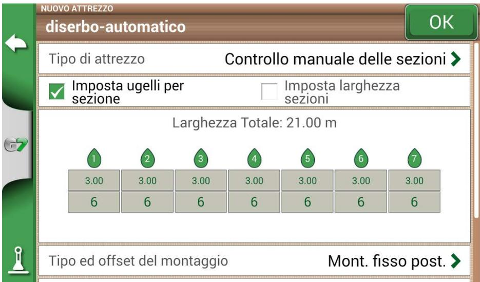
Figura 4.10.e - Configurazione delle sezioni: ugelli per sezione
