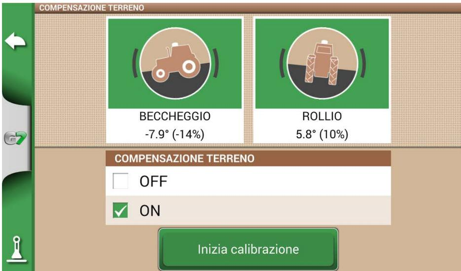
Figura 2.4.1.c - Attivazione compensazione terreno, visualizzazione beccheggio/rollio
