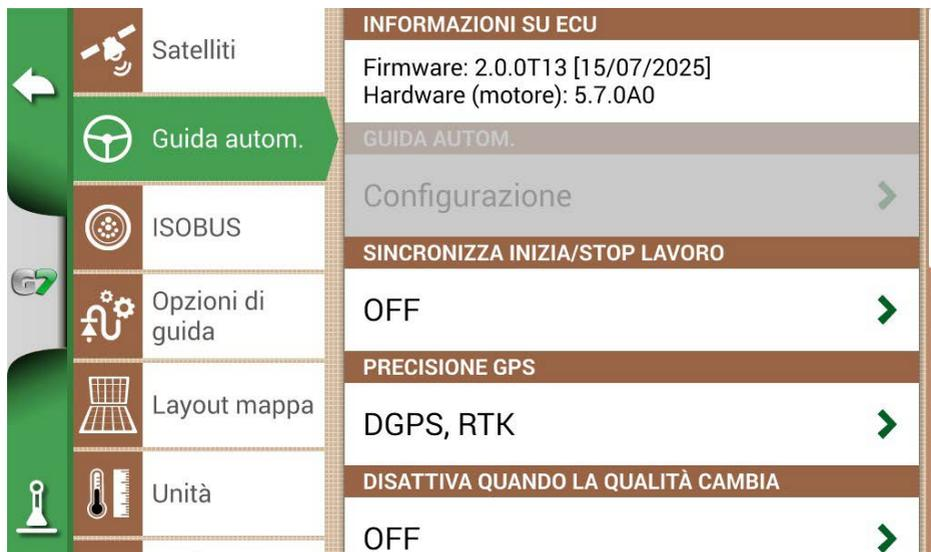
Figura 2.4.3.2.a – Pagina di configurazione della guida automatica Pilota
