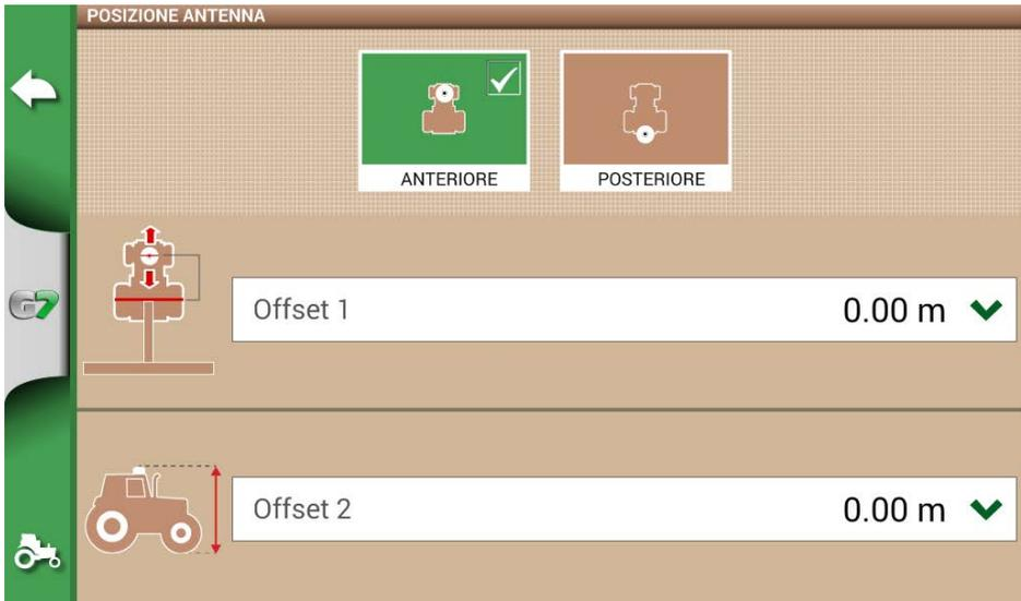
Figura 2.4.2 - Pagina di configurazione della posizione dell'antenna
