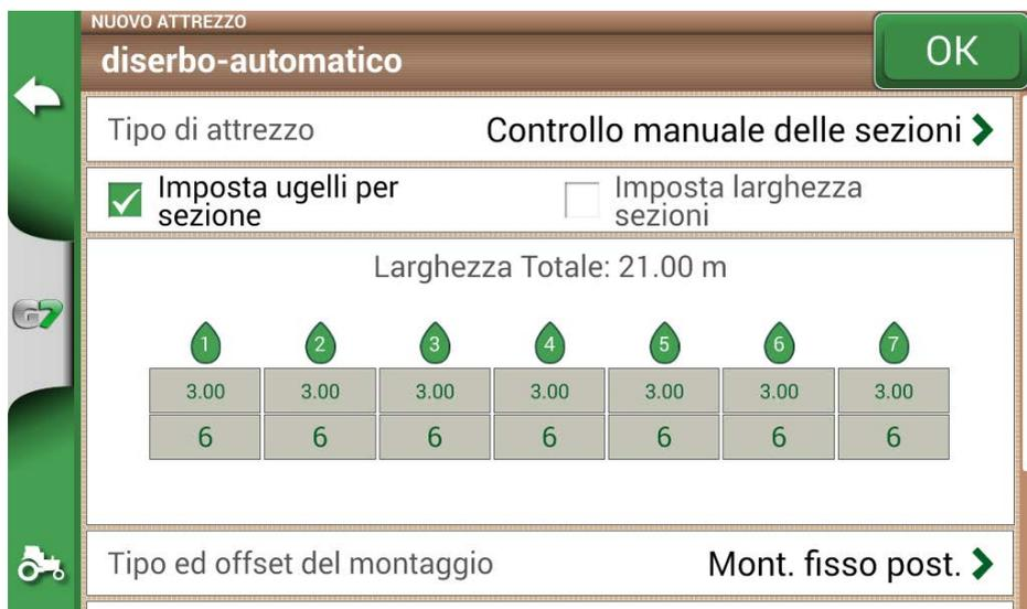
Figura 4.10.e - Configurazione delle sezioni: ugelli per sezione
