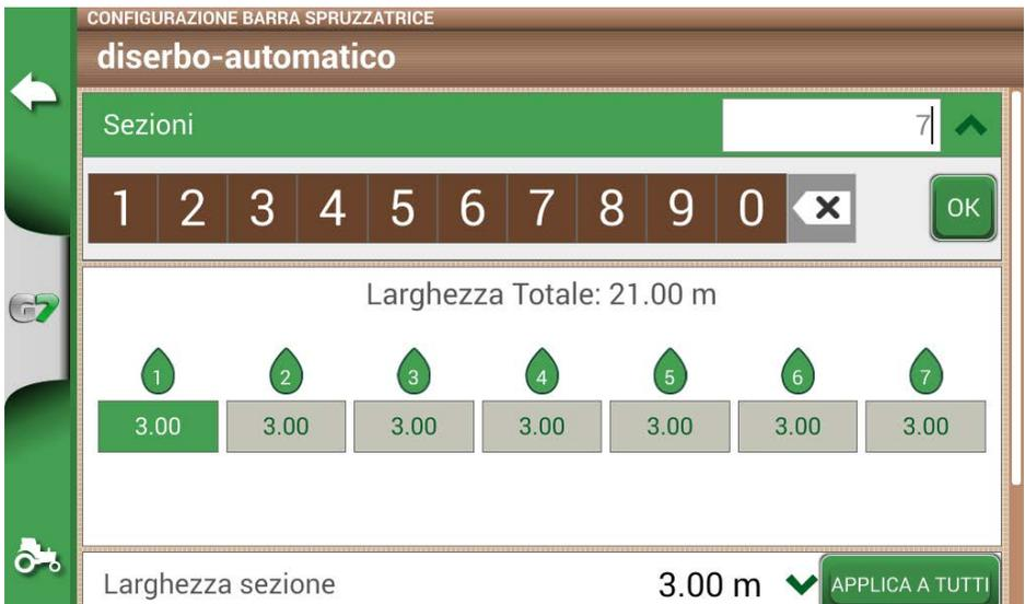
Figura 4.10.g - Configurazione del numero di sezioni
