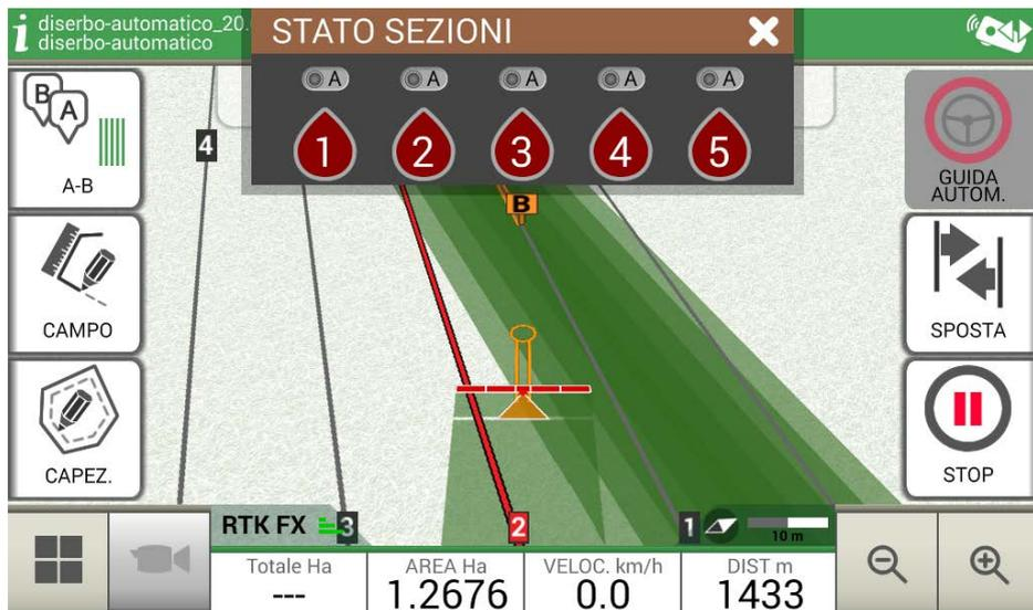
Figura 4.10.m - Barra di stato delle sezioni
