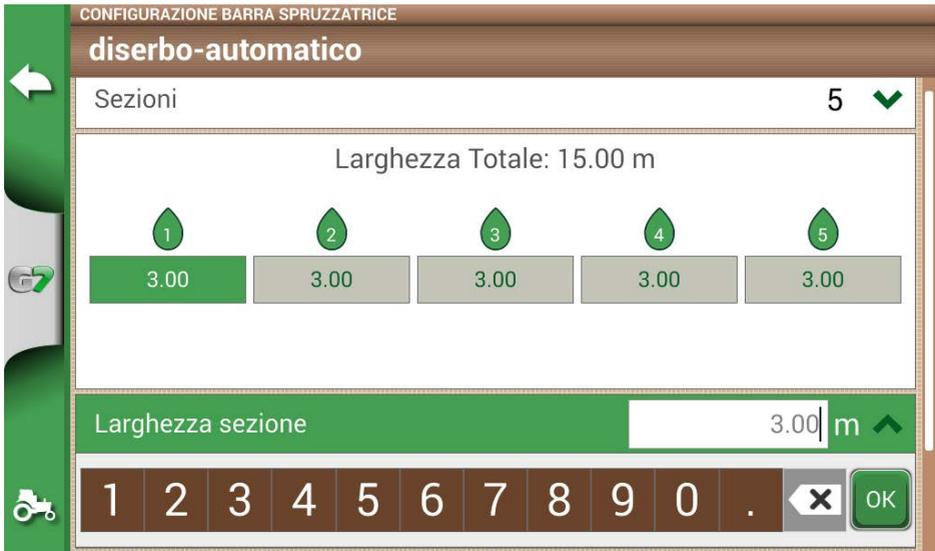
Figura 4.10.h - Configurazione della larghezza della singola sezione
