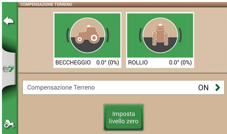
Figura 2.4.1.d – Calibrazione a zero della compensazione terreno
