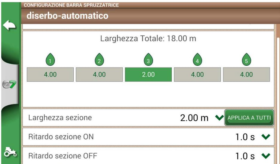
Figura 4.10.i - Esempio di una barra da 18 m con 5 sezioni
