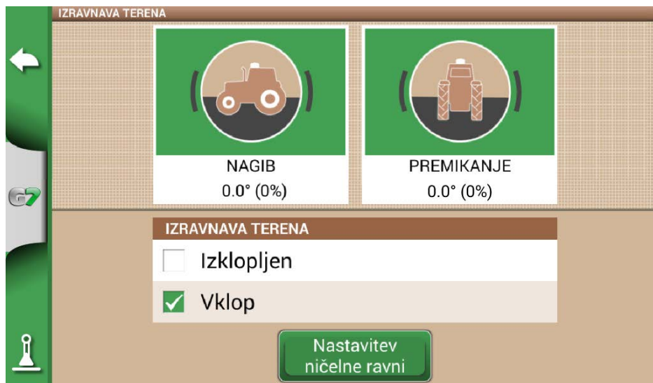
Slika 2.4.1.d – Ničelna kalibracija kompenzacije terena
