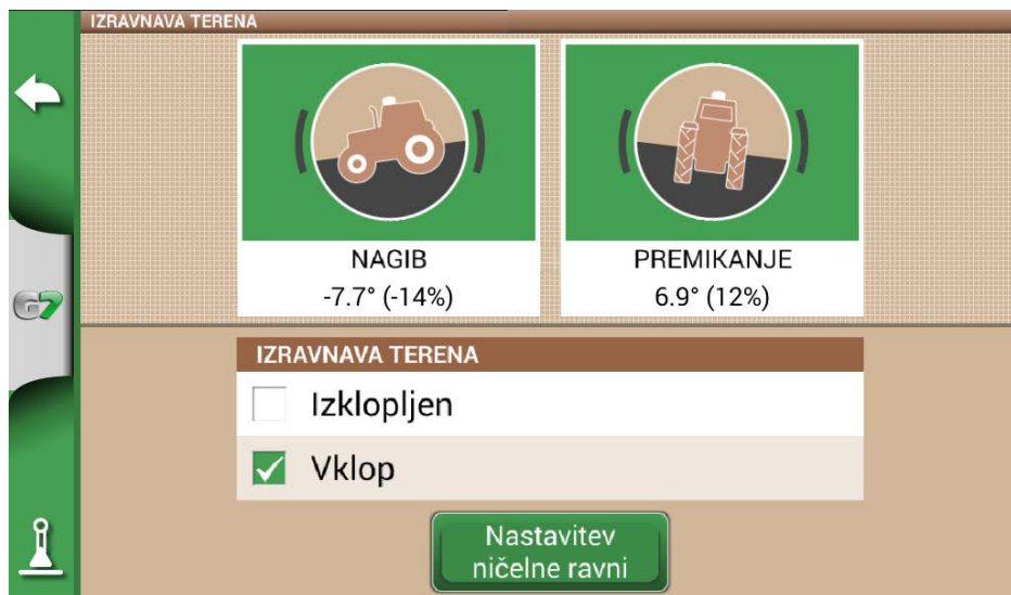
Slika 2.4.1.c – Aktivacija kompenzacije terena, prikaz naklona / nagiba
