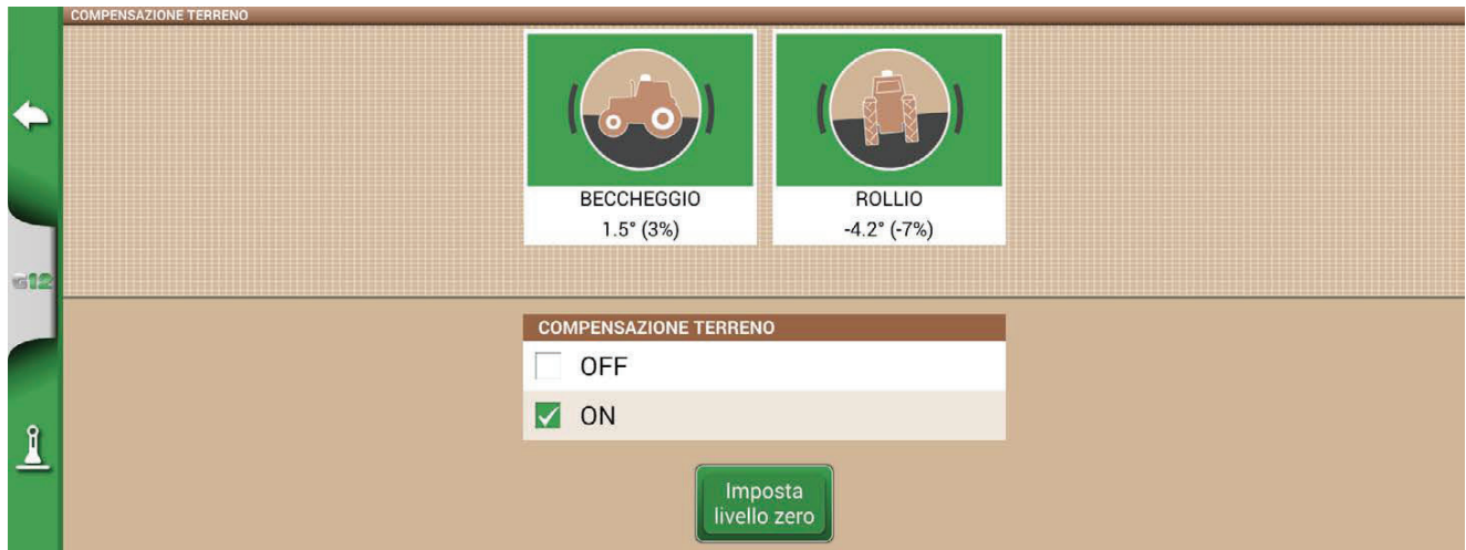
Figura 2.4.1.c – Activación de compensación del terreno, visualización de cabeceo/balanceo
