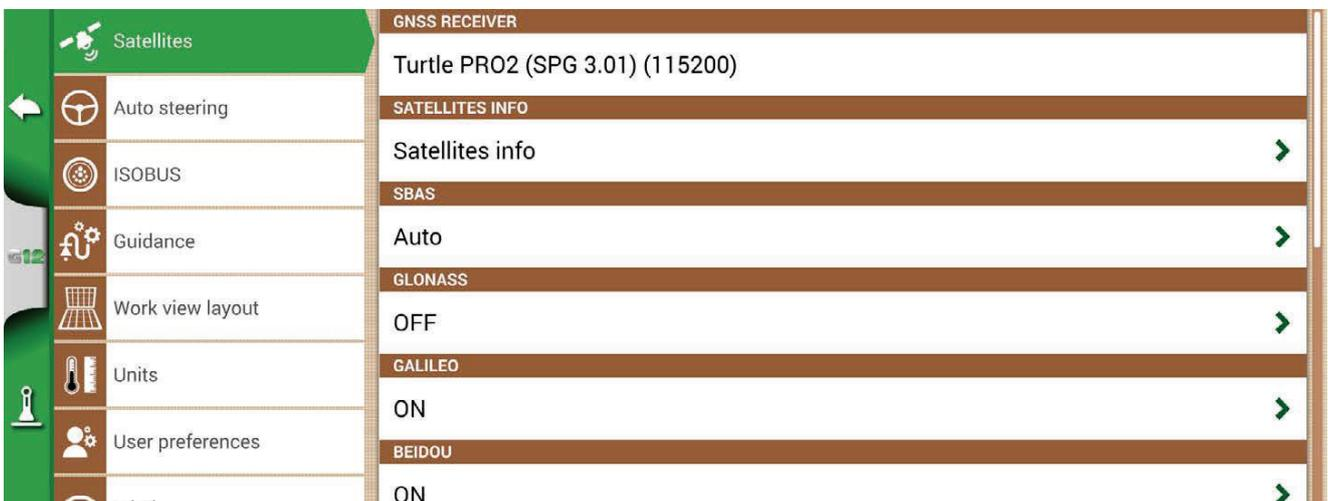
Por meio desta página, você pode verificar o status dos satélites e alterar algumas configurações do receptor GNSS. As configurações do receptor GNSS dependem do modelo usado, portanto, a aparência do menu pode mudar. Em detalhes, as várias configurações relacionadas aos satélites.
