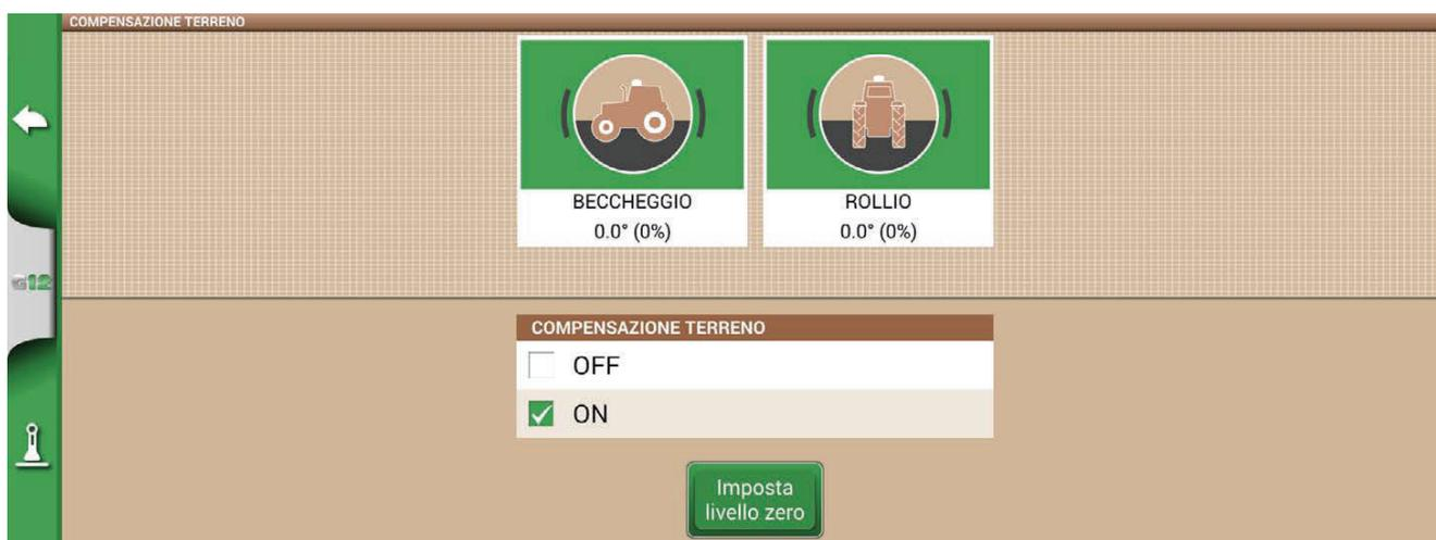
Figura 2.4.1.d – Calibrazione a zero della compensazione terreno
