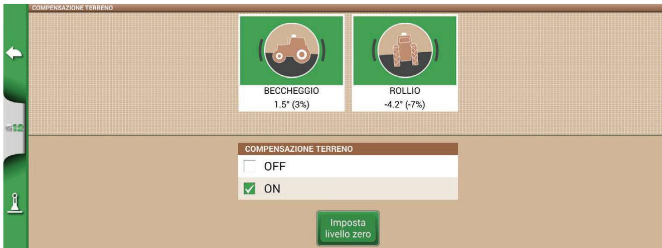
Figura 2.4.1.c – Attivazione compensazione terreno, visualizzazione beccheggio/rollio
