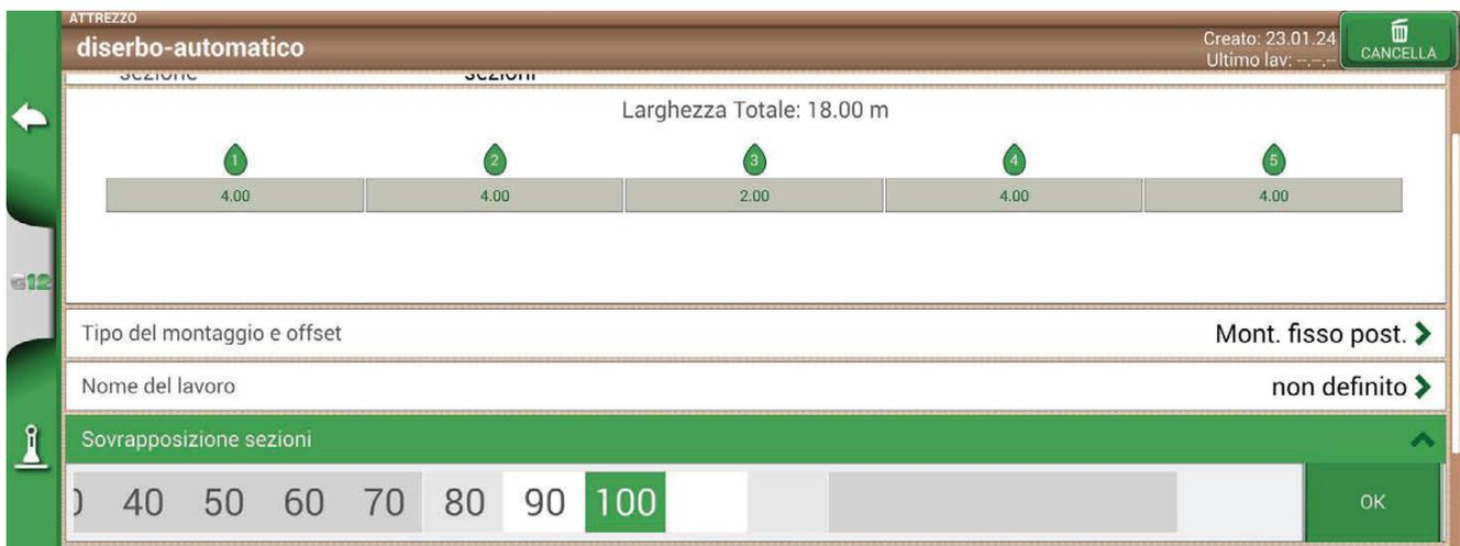
Figura 4.9.k - Configurazione della percentuale di sovrapposizione
