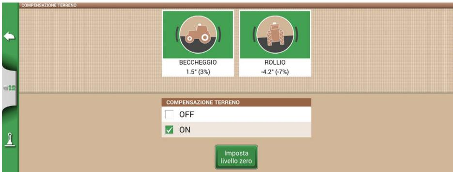
Figura 2.4.1.c - Attivazione compensazione terreno, visualizzazione beccheggio/rollio
