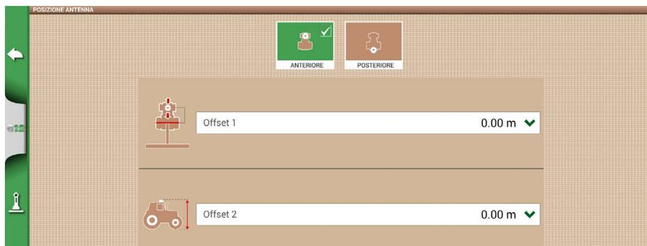
Figura 2.4.2 - Pagina di configurazione della posizione dell'antenna
