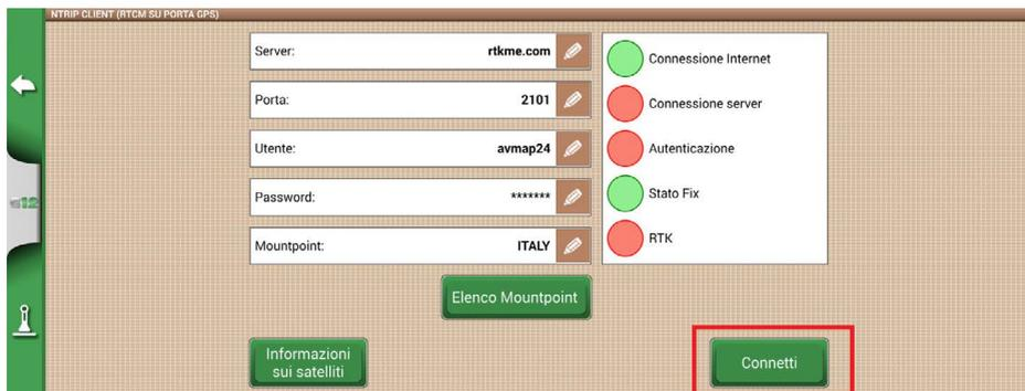
Figura 6.2.2.b - Configurazione accesso NTRIP Client
