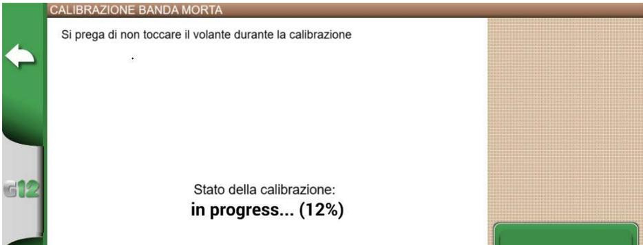
*Figura 2.4.3.2.d – Avvio della calibrazione della banda morta*
