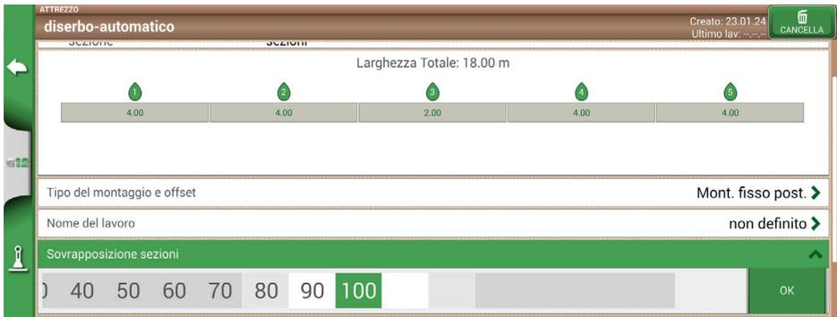
Figura 4.9.k - Configurazione della percentuale di sovrapposizione
