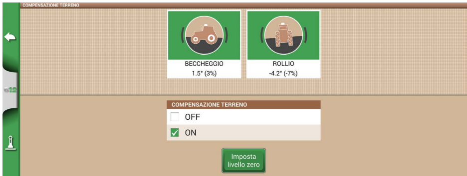
Figura 2.4.1.c – Attivazione compensazione terreno, visualizzazione beccheggio/rollio
