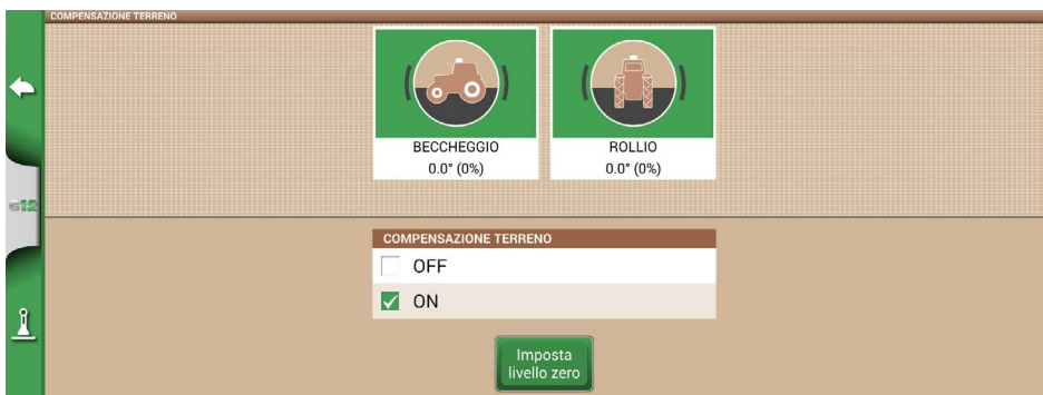
Figura 2.4.1.d – Calibrazione a zero della compensazione terreno
