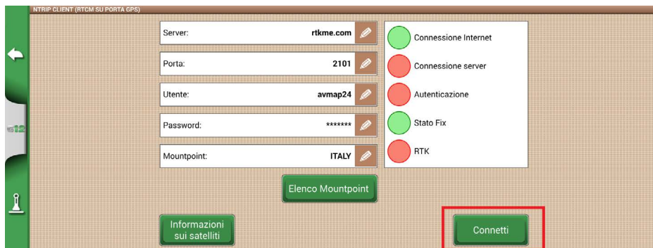
Figura 6.2.2.b - Configurazione accesso NTRIP Client
