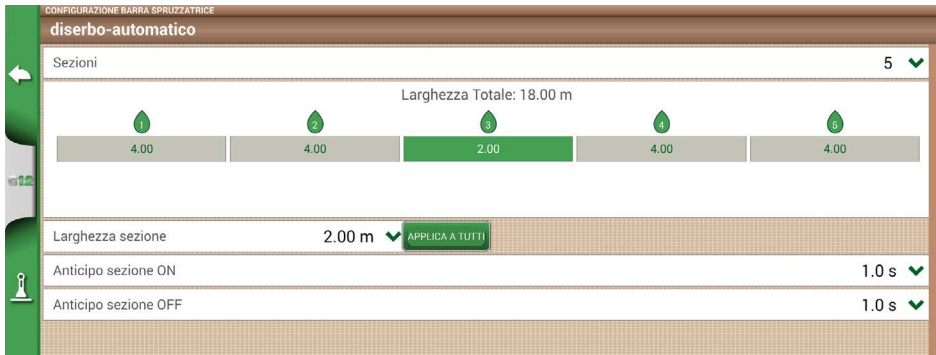
Figura 4.9.j - Configurazione dei ritardi di apertura e chiusura della sezione
