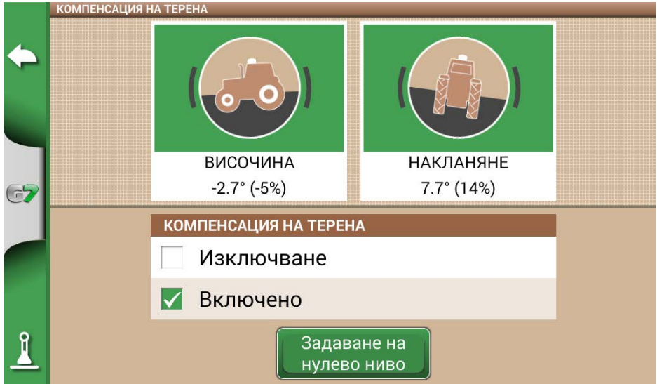
Фигура 2.4.1.в – Активиране на компенсацията на терена, показване на надлъжно/странично накланяне
