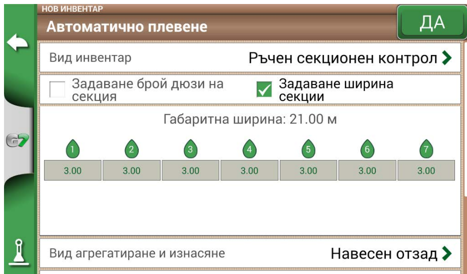
Фигура 4.10.е – Конфигурация на участъците: ширина на участъка
