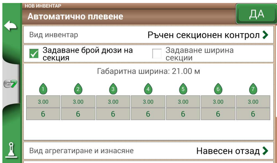
Фигура 4.10.д – Конфигурация на участъците: дюза за всеки участък
