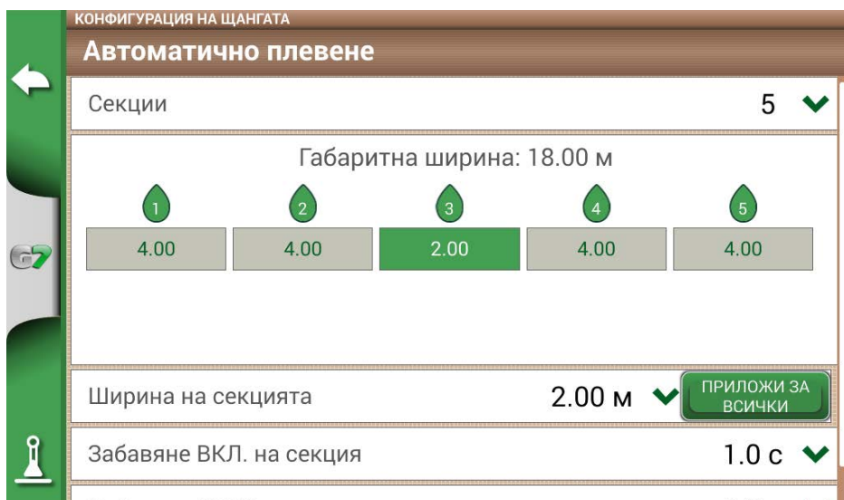
Фигура 4.10.и – Пример за 18-метрова шина с 5 участъка
