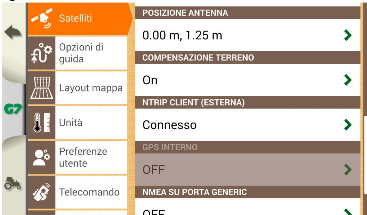
Figura 2.3.1.b - Satelliti - Impostazioni principali ricevitore
