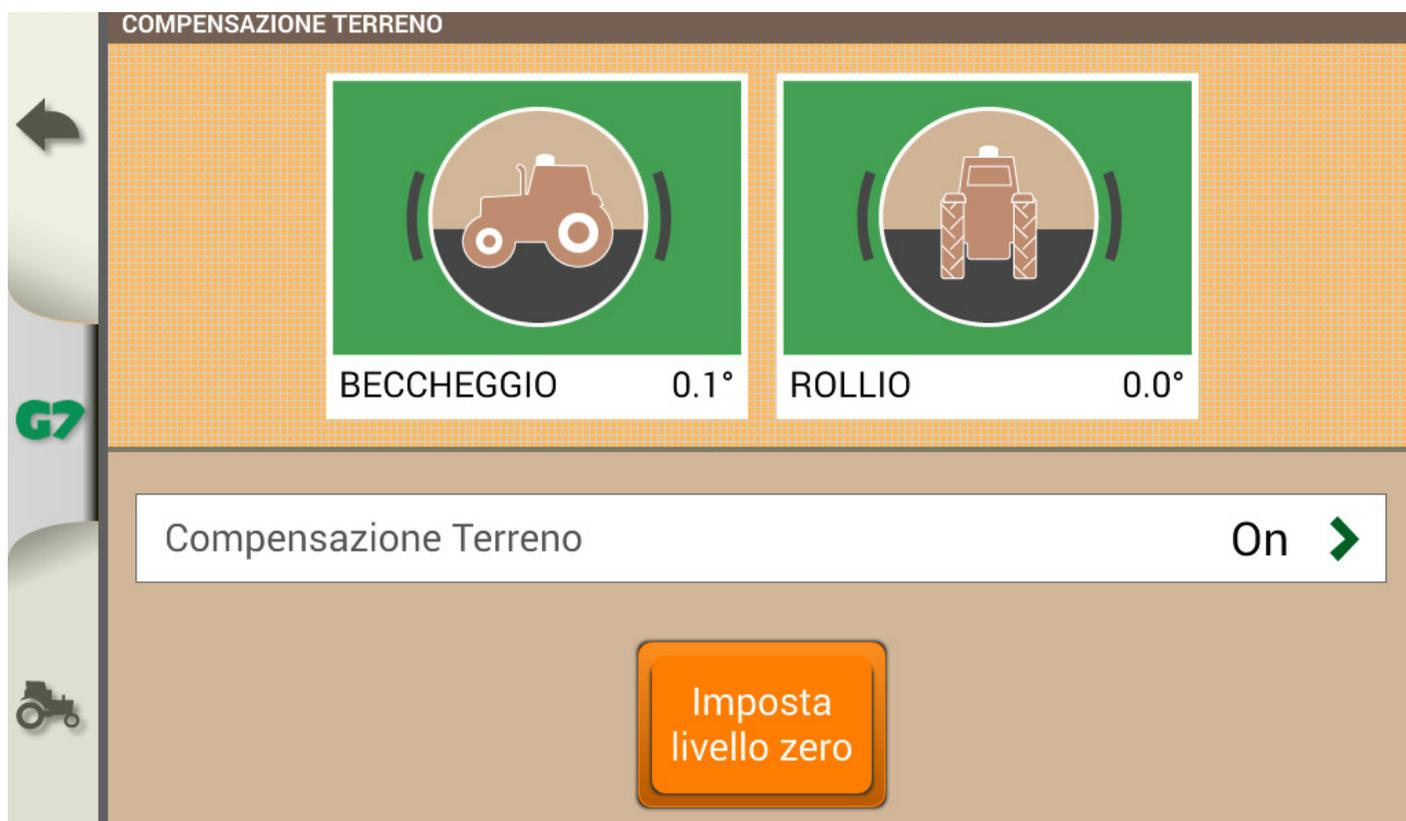
Figura 2.3.1.d - Imposta livello zero compensazione terreno
