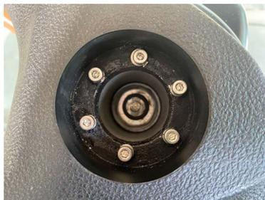
4. Collegare l'adattatore scanalato al retro del motore elettrico utilizzando le 6 viti fornite;
