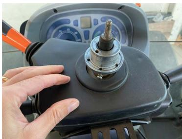
3. Fissare il volante fornito al motore utilizzando le 6 viti incluse;
