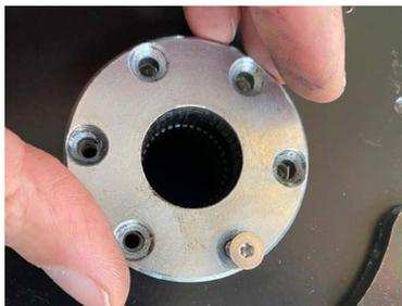
5. Fissare la staffa di supporto sotto il motore e collegare il perno anti-rotazione;
