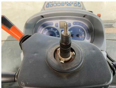
2. Una volta rimosso il volante, verificare che il kit di installazione sia corretto. Inserire l'adattatore scanalato nella colonna dello sterzo e controllare il corretto accoppiamento meccanico;
