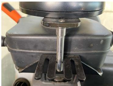
6. Inserire il motore elettrico completo di volante, adattatore scanalato e perno anti-rotazione sulla colonna dello sterzo del veicolo. Controllare che l'accoppiamento sia ben fatto e privo di gioco;
