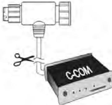
C-COM – Kabel abschneiden (5 cm vom T-Stecker entfernt)
