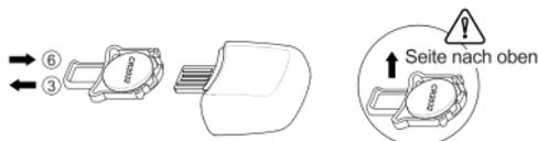
7. Schließen Sie den Schlüssel, indem Sie die Oberschale in die Unterschale schieben
